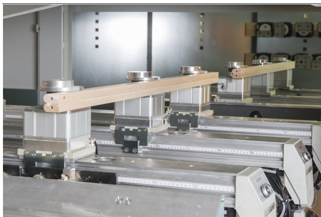
Механические зажимы VCMC-K1 для зажима деталей рамы
